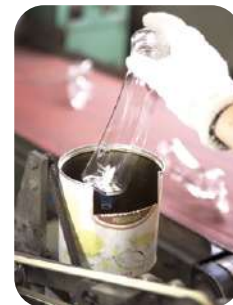
カットした後の処理。丁寧な手作業でバリを完全に取りきる。
